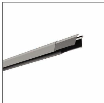
Licross, Tragschiene, aus Stahlblech, verzinkt, bandlackiert, weißaluminium (RAL 9006), Länge: 1.500 mm, Breite: 64 mm, Höhe: 67mm, Durchverdrahtung: 11x 2,5mm<sup>2</sup> (2x DALI, 1x Notlicht), Schutzart (gesamt): maximal IP64, abhängig von den verwendeten Einsätzen und Zubehören, Schutzklasse (gesamt): SK I (Schutzerdung), Prüfzeichen: CE, UKCA, LABS-Konformität geprüft gemäß VDMA 24364:2018-05, Verpackungseinheit: 1 Stück
