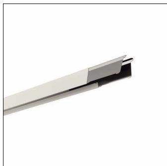
Licross, Tragschiene, aus Stahlblech, verzinkt, bandlackiert, weiß, Länge: 3.000 mm, Breite: 64 mm, Höhe: 67mm, Durchverdrahtung: 11x 2,5mm<sup>2</sup> (2x DALI, 1x Notlicht), Schutzart (gesamt): maximal IP64, abhängig von den verwendeten Einsätzen und Zubehören, Schutzklasse (gesamt): SK I (Schutzerdung), Prüfzeichen: CE, UKCA, LABS-Konformität geprüft gemäß VDMA 24364:2018-05, Verpackungseinheit: 1 Stück
