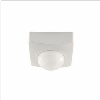
SITECO ConnectSensor-Head PC5-M, Master, lokale Steuerung - autarke standalone Sensorik, schaltbar, dimmbar, Montageart: Einsteckmontage, Montageort: an der Licross® Tragschiene, an der Modario® Tragschiene, an der Decke, aus Kunststoff, Schutzart (gesamt): IP54, Prüfzeichen: CE, VDE, 1 x PIR-Bewegungssensor, 1 x Lichtsensor, 1 x IR-Empfänger, Verpackungseinheit: 1 Stück
