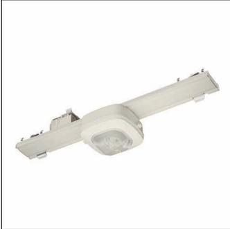
Licross®Sensor PS2, Slave, zentrale Steuerung - Anbindung an Licht- oder Gebäudemanagement, dimmbar, Montageart: Einbau, Montageort: an der Licross® Tragschiene, aus Stahlblech, Schutzart (gesamt): IP20, Schutzklasse (gesamt): SK I (Schutzerdung), Prüfzeichen: CE, UKCA, 1 x PIR-Bewegungssensor, 1 x Lichtsensor, 1 x DALI, Verpackungseinheit: 1 Stück
