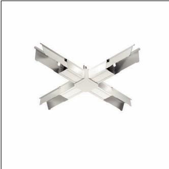
Licross®, X-Verbinder, Tragschienen-Element, aus Stahl, verzinkt, lackiert, weiß, Länge: 300mm, Breite: 300mm, Höhe: 67mm, Blindabdeckung, aus PC/ABS, weiß, Verbinder, aus Stahl, verzinkt, Schutzart (gesamt): für Schutzart IP20/IP40, Prüfzeichen: CE, UKCA, Verpackungseinheit: 1 Stück
