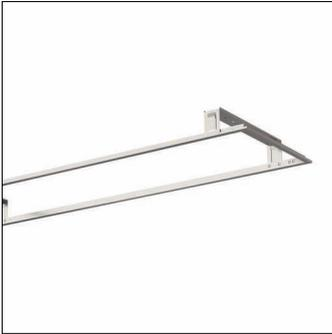
Sport 31, Deckeneinbaurahmen, Montageart: Einbau, Einbau-Rahmen, aus Stahlblech, verkehrsweiß (RAL 9016), inkl. Schrauben, Länge: 1.582mm, Breite: 458mm, Höhe: 105mm, Klemmbereich: 10..60mm, Verpackungseinheit: 1 Stück
