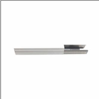
Modario® 31 Anschlussraum, weiß; Anschlussraum aus Stahlblech, verzinkt, lackiert, mit Leitungseinführung für vier Leitungen, Ø 8, 5..13mm; 2x Stirnwand 1x Blindabdeckung aus PC/ABS, weiß; 1x Verbinder aus Stahl, verzinkt, Verbinder an Tragschiene vormontiert; Abmessung: (LxBxH) = 299 x 58 x 43mm; IP40; Schutzklasse: SK I (Schutzerdung); Prüfzeichen: CE, UKCA; Verpackungseinheit: 1 Stück
