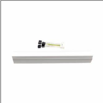
Modario® 31 Ausspeisung, weiß; Verdrahtung Anschlussraum aus Stahlblech, verzinkt, lackiert, mit Leitungseinführung für vier Leitungen, Ø 8, 5..13mm; 1x Blindabdeckung aus PC/ABS, weiß; Anschluss über Klemme, 10polig, max. 2,5mm<sup>2</sup>, interne Verdrahtung halogenfrei; Abmessung: (LxBxH) = 449 x 58 x 43mm; IP40; Schutzklasse: SK I (Schutzerdung); Prüfzeichen: CE, UKCA; Verpackungseinheit: 1 Stück
