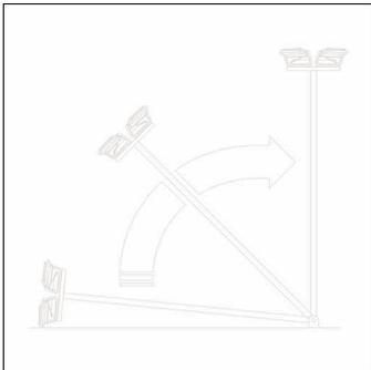
Mast, Kippmast, Montageart: Schraubbefestigung, Kippmast, aus Stahl, verzinkt, für bis zu 4 Stk. Floodlight FL 11 maxi pro in Windzone 1, für bis zu 3 Stk. Floodlight FL 11 maxi pro in Windzone 2, Höhe: 15,6m, Masttüre, aus Stahl, verzinkt, Breite: 125mm, Höhe: 410mm, Norm: DIN EN 40, Verpackungseinheit: 1 Stück
