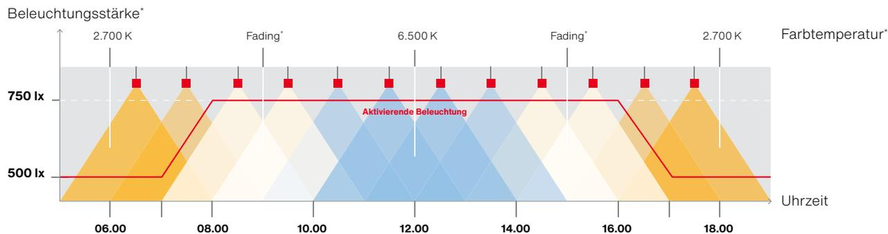
\* Projektspezifische Auslegung nach DIN SPEC 67600, 5031-100 und EN 12464-1
