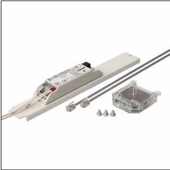
Monsun® 11/21, kit maestro DALIeco, tipo de montaje: empotrado, con cable con conector RJ-11 + 4x conductor 0,75mm<sup>2</sup>, CA, 50/60Hz, longitud: 250mm, ancho: 34mm, altura: 29mm, controlador DALIeco, maestro, sensor HC1, sensor de luz desactivado, marca de verificación: CE, temperatura ambiente de funcionamiento admisible: -25..+35°C, unidad de embalaje: 1 unidad
