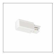
AX T, alimentación inicial, tipo de montaje: empotrado, montaje superficial, de plástico, blanco, conductor neutro dcha., para barra conductora trifásica, marca de verificación: CE, unidad de embalaje: 1 unidad
