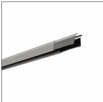
Licross®, carril de soporte, de chapa de acero, galvanizado, cinta lacada, aluminio blanco (RAL 9006), longitud: 3.000 mm, ancho: 64 mm, altura: 67mm, tipo de protección (total): como máximo IP64, dependiendo de los apliques y accesorios utilizados, clase de protección (total): SK I (protección por puesta a tierra), marca de verificación: CE, UKCA, conformidad LABS probada según VDMA 24364:2018-05, unidad de embalaje: 1 unidad
