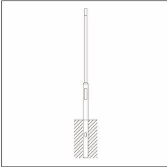
mástil, mástil, cilíndrico desplazado, de acero, galvanizado, altura: 4,5m, espiga: 76mm (superior), sección plantada: h= 800mm / Ø= 114mm, norma: DIN EN 40, unidad de embalaje: 1 unidad
