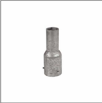
reductor, tipo de montaje: superior, casquillo reductor, de St 37-2, galvanizado, longitud: 230mm, diámetro: 60mm, espiga: 76/60mm, unidad de embalaje: 1 unidad
