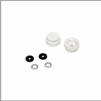
Monsun® 21 Gen.1, fijación de pared, tipo de montaje: montaje horizontal, montaje vertical, conjunto de montaje de pared, de EPDM, el conjunto de sellado para montaje en pared contiene 2x junta, disco de refuerzo y cubierta para tornillos ( $\varnothing = 5\text{mm}$ , suministro sin tornillos), unidad de embalaje: 1 conjunto = 2 unidades
