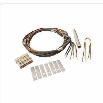
Monsun 21 Gen.1, cableado transversal, tipo de montaje: empotrado, conjunto de cableado transversal, 5 conductores, 1, 5mm<sup>2</sup>, longitud de cable: 1,6m, clema, 5 polos, máx. 2,5mm<sup>2</sup>, con conductor protector, clase de protección (total): SK I (protección por puesta a tierra), unidad de embalaje: 1 unidad
