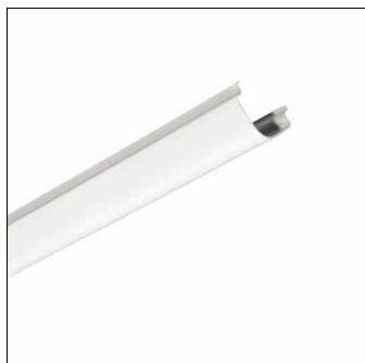
accesorio de carcasa, para DUS, carril de montaje, DUS IP20, cubierta ciega, convexo, de plástico, sin tratamiento, gris claro (RAL 7035), longitud: 1.596 mm, ancho: 63 mm, altura: 41mm, tipo de protección (total): IP20, unidad de embalaje: 1 unidad
