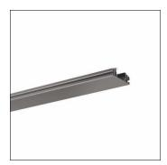
Vega® 11, carril de montaje, tipo de montaje: montaje suspendido, con borne, 3+3 polos, máx. 2,5mm², carril, de perfil extruido de aluminio, anodizado, natural, longitud: 4.000 mm, ancho: 64 mm, altura: 22mm, tipo de protección (total): IP20, marca de verificación: CE, unidad de embalaje: 1 unidad
