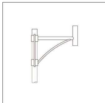
balancín, cruceta de mástil, brazo de diseño, de acero, galvanizado y lacado, SITECO gris metalizado (DB 702S), 1 brazo, con cierre de mástil integrado, espiga: 76mm (superior), dimensiones de brazo: 600mm, unidad de embalaje: 1 unidad
