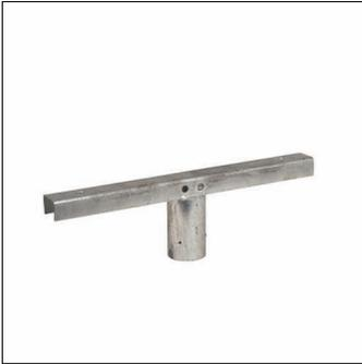
SiCOMPACT® A2 MIDI, grupo constructivo de montaje, travesaño para 2 proyectores, de acero, galvanizado, tipo 1: superior, longitud: 660 mm, espiga: 76mm (superior), unidad de embalaje: 1 unidad
