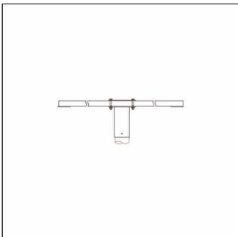
Floodlight FL 20 maxiFloodlight FL 20 midi, grupo constructivo de montaje, travesaño para 2..4 proyectores, de acero, galvanizado, tipo 1: superior, longitud: 1.200mm, espiga: 89..108mm, unidad de embalaje: 1 unidad
