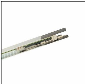
Modario®, carril de soporte, de chapa de acero, lacado, blanco brillante, 1 longitud, longitud: 1.495 mm, ancho: 58 mm, altura: 43mm, cableado transversal: 5x 2,5mm<sup>2</sup>, con borne, 5 polos, máx. 2,5mm<sup>2</sup>, tipo de protección (total): para tipo de protección IP20/IP40, clase de protección (total): SK I (protección por puesta a tierra), marca de verificación: CE, ENEC, VDE, norma: EN 60598, unidad de embalaje: 1 unidad
