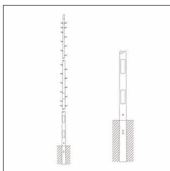
mástil, mástil con peldaños, cónico redondo, de acero, galvanizado, tipo 1: superior, diámetro: 108 mm, altura: 16m, espiga: 108mm, unidad de embalaje: 1 unidad
