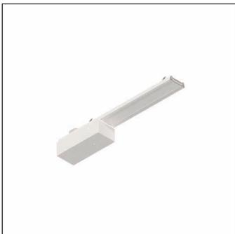
SITECO Connect IP Gen.1, aplique de carril, conexión IP LAN, con conector, 6 polos, con selección de fase, conexión de alimentación: 230V, CA, 50Hz, adaptador, de chapa de acero, cinta lacada, blanco (RAL 9016), longitud: 450mm, ancho: 64mm, altura: 38mm, tipo de protección (total): IP40, clase de protección (total): SK I (protección por puesta a tierra), marca de verificación: CE, UKCA, unidad de embalaje: 1 unidad
