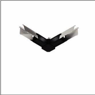
Licross®, unión en L, elemento de carril de soporte, de acero, galvanizado, lacado, negro intenso (RAL 9005), longitud: 197mm, ancho: 197mm, altura: 67mm, cubierta ciega, de PC/ABS, negro intenso (RAL 9005), conector, de acero, galvanizado, tipo de protección (total): para tipo de protección IP20/IP40, marca de verificación: CE, UKCA, unidad de embalaje: 1 unidad
