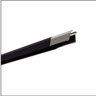
Licross®, carril de soporte, de chapa de acero, galvanizado, cinta lacada, negro intenso (RAL 9005), longitud: 3.000 mm, ancho: 64 mm, altura: 67mm, cableado transversal: 11x 2,5mm<sup>2</sup>, tipo de protección (total): como máximo IP64, dependiendo de los apliques y accesorios utilizados, clase de protección (total): SK I (protección por puesta a tierra), marca de verificación: CE, UKCA, conformidad LABS probada según VDMA 24364:2018-05, unidad de embalaje: 1 unidad
