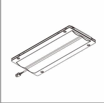
Streetlight 10 mini/midi, módulo LED, control de luz directo con óptica de carril-bici, distribución de luz: P1.0a, característica de iluminación directa: asimétrico, alto Power LED, color de luz: 830, temperatura de color: 3000K, conexión de alimentación: 230..240V, 50Hz, módulo LED, longitud: 310mm, ancho: 137mm, altura: 40mm, tipo de protección (total): como luminaria, unidad de embalaje: 1 unidad
