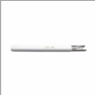
Modario® 31 compartimento de conexiones central, blanco; compartimento de conexiones central de chapa de acero, galvanizado, lacado, con entrada de cable para cuatro cableados, Ø 8, 5..13mm; 1x cubierta ciega de PC/ABS, blanco, 1x conector de acero, galvanizado, dimensión: (LxAnxAI) = 598 x 58 x 43mm; IP40; clase de aislamiento: SK I (protección por puesta a tierra); marca de verificación: CE, UKCA; unidad de embalaje: 1 unidad
