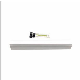
Modario® 31 alimentador de salida, blanco; cableado compartimento de conexión de chapa de acero, galvanizado, lacado, con entrada de cable para cuatro cableados, Ø 8, 5..13mm; 1x cubierta ciega de PC/ABS, blanco; conexión vía borne, 10 polos, máx. 2,5mm<sup>2</sup>, cableado interno libre de halógenos; dimensión: (LxAxAI) = 449 x 58 x 43mm; IP40; clase de aislamiento: SK I (protección por puesta a tierra); marca de verificación: CE, UKCA; unidad de embalaje: 1 unidad
