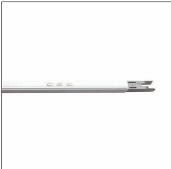
Modario® 31 compartimento de conexiones central, blanco; compartimento de conexiones central de chapa de acero, galvanizado, lacado, con entrada de cable para seis cableados, Ø 8, 5..13mm; 1x cubierta ciega de PC/ABS, blanco, 1x conector de acero, galvanizado, dimensión: (LxAnxAI) = 897 x 58 x 43mm; IP40; clase de aislamiento: SK I (protección por puesta a tierra); marca de verificación: CE, UKCA; unidad de embalaje: 1 unidad
