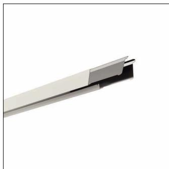
Licross, rail, en tôle d'acier, galvanisé, laqué en bande, blanc, longueur: 4.500 mm, largeur: 64 mm, hauteur: 67mm, câblage continu: 5x 2,5mm<sup>2</sup>, degré de protection (total): max. IP64, en fonction des éléments et accessoires utilisés, classe de protection (total): classe de protection I (mise à la terre), marquage: CE, UKCA, conformité LABS testée selon VDMA 24364:2018-05, unité d'emballage: 1 pièce
