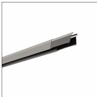
Licross, rail, en tôle d'acier, galvanisé, laqué en bande, aluminium blanc (RAL 9006), longueur: 3.000 mm, largeur: 64 mm, hauteur: 67mm, câblage continu: 14x 2,5mm<sup>2</sup>, degré de protection (total): max. IP64, en fonction des éléments et accessoires utilisés, classe de protection (total): classe de protection I (mise à la terre), marquage: CE, UKCA, conformité LABS testée selon VDMA 24364:2018-05, unité d'emballage: 1 pièce
