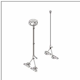
Apollon® 2, suspension par câble en Y, douille de plafond, avec avec 4 bornes, 1 broche, max. 2,5mm<sup>2</sup> (sans câble de raccordement), câble de raccordement, 4x 0,75mm<sup>2</sup>, élément de fixation au plafond, en acier, galvanisé, cache piton, en plastique, câble, en acier, galvanisé, fixation côté luminaire, en acier, galvanisé, douille de plafond, en acier, nickelé, unité d'emballage: 1 jeu = 2 pièces
