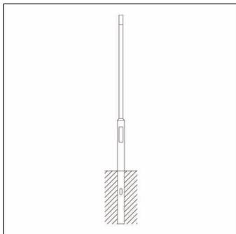
mât, mât, cylindrique, désaxé, en acier, galvanisé, hauteur: 5,0m, embout : 76mm (au sommet du mât), boîtier enterré: h= 800mm / Ø= 114mm, norme: DIN EN 40, unité d'emballage: 1 pièce
