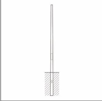
mât, mât, cylindro-conique, en acier, galvanisé, hauteur: 4,0m, embout : 76mm (au sommet du mât), boîtier enterré: h= 800mm / Ø= 129mm, norme: DIN EN 40, unité d'emballage: 1 pièce
