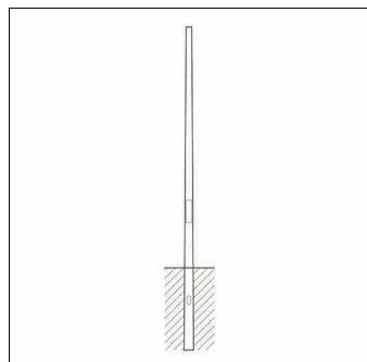
mât, mât, cylindro-conique, en acier, thermolaqué, fer micacé SITECO (DB 702S), hauteur: 3m, embout : 76mm (au sommet du mât), boîtier enterré: h= 600mm / Ø= 126mm, norme: DIN EN 40, unité d'emballage: 1 pièce
