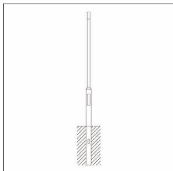
mât, mât, cylindrique, désaxé, en acier, thermolaqué, fer micacé SITECO (DB 702S), hauteur: 4,5m, embout : 76mm (au sommet du mât), boîtier enterré: h= 800mm / Ø= 114mm, norme: DIN EN 40, unité d'emballage: 1 pièce
