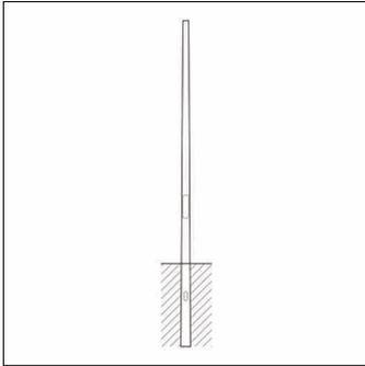
mât, mât, cylindro-conique, en acier, galvanisé, hauteur: 5,0m, embout : 60mm (au sommet du mât), boîtier enterré: h= 800mm / Ø= 130mm, norme: DIN EN 40, unité d'emballage: 1 pièce
