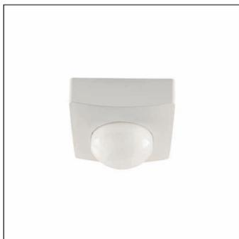
SITECO ConnectSensor-Head PR2-M, maître, contrôle local - technologie de capteur autonome, commutable, gradable, type de pose: montage par broches, emplacement de pose: sur l'interface, en plastique, degré de protection (total): IP54, marquage: CE, VDE, 1 x capteur de présence PIR, 1 x capteur de luminosité, 1 x récepteur IR, unité d'emballage: 1 pièce
