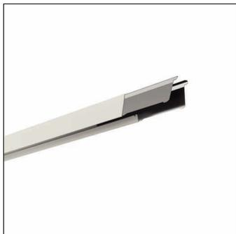
Licross®, rail, en tôle d'acier, galvanisé, laqué en bande, blanc, longueur: 1.500 mm, largeur: 64 mm, hauteur: 67mm, câblage continu: 5x 2,5mm<sup>2</sup>, degré de protection (total): max. IP64, en fonction des éléments et accessoires utilisés, classe de protection (total): classe de protection I (mise à la terre), marquage: CE, UKCA, conformité LABS testée selon VDMA 24364:2018-05, unité d'emballage: 1 pièce
