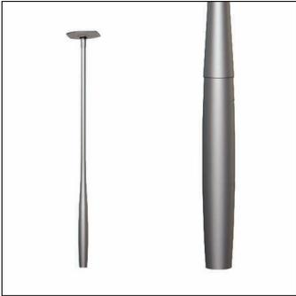
mât, mât, cylindro-conique, en aluminium, laqué, fer micacé Siteco® (DB 702S), hauteur: 4,0m, embout : 76mm (au sommet du mât), boîtier enterré: h= 800mm / Ø= 140mm, norme: DIN EN 40, unité d'emballage: 1 pièce
