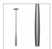
mât, mât, cylindro-conique, en aluminium, laqué, fer micacé Siteco® (DB 702S), hauteur: 6,0m, embout : 76mm (au sommet du mât), boîtier enterré: h= 1000mm / Ø= 140mm, norme: DIN EN 40, unité d'emballage: 1 pièce
