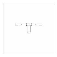
Floodlight FL 20 maxiFloodlight FL 20 midi, module montage, traverse pour 2 à 4 projecteurs, en acier, galvanisé, type 1 : au sommet du mât, longueur: 1.200mm, embout : 89 á 108mm, unité d'emballage: 1 pièce
