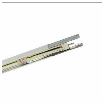
Modario, rail, en tôle d'acier, laqué, blanc brillant, à deux longueurs, longueur: 2.392 mm, largeur: 58 mm, hauteur: 43mm, câblage continu: 10x 2,5mm<sup>2</sup>, avec borne, 10 broches, 2,5mm<sup>2</sup> max., degré de protection (total): pour un degré de protection IP20/IP40, classe de protection (total): classe de protection I (mise à la terre), marquage: CE, ENEC, VDE, norme: EN 60598, unité d'emballage: 1 pièce
