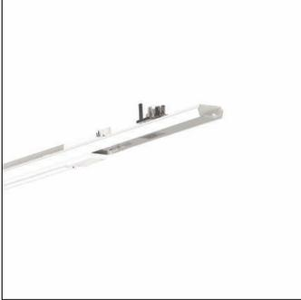
Modario®, élément de rail électrique, avec connecteur mâle, 5 broches, avec sélection de phase, pour rail, 10 conducteurs, raccordement au secteur: 230/400V, élément de rail électrique, en tôle d'acier, laqué en bande, blanc brillant, 2x dimension du système, poids admissible 5kg max., longueur: 598mm, largeur: 48mm, degré de protection (total): pour un degré de protection IP20, classe de protection (total): classe de protection I (mise à la terre), marquage: CE, unité d'emballage: 1 pièce
