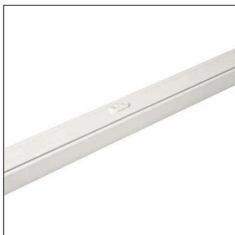
accessoires, boîtier, pour Modario® IP64, rail, entrée/sortie d'alimentation supplémentaire, en acier, galvanisé, laqué, blanc brillant, 5x dimension du système, longueur: 1.495 mm, largeur: 58 mm, hauteur: 43mm, câblage continu: 10x 2,5mm<sup>2</sup>, degré de protection (total): pour un degré de protection IP64, classe de protection (total): classe de protection I (mise à la terre), marquage: CE, UKCA, unité d'emballage: 1 pièce
