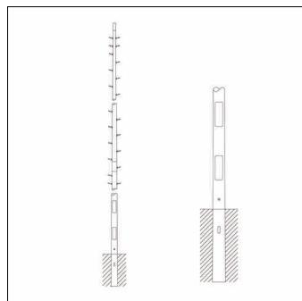
mât, mât avec marche, cylindro-conique, en acier, galvanisé, type 1 : au sommet du mât, diamètre: 108 mm, hauteur: 16m, embout : 108mm, unité d'emballage: 1 pièce
