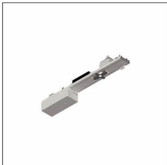
SITECO Connect IP Gen.1, élément du rail, adaptateur universel PoE, avec connecteur mâle, 6 broches, avec sélection de phase, raccordement au secteur: 230V, AC, 50Hz, adaptateur, en tôle d'acier, laqué en bande, aluminium blanc (RAL 9006), longueur: 500mm, largeur: 64mm, hauteur: 65mm, degré de protection (total): IP40, classe de protection (total): classe de protection I (mise à la terre), marquage: CE, UKCA, unité d'emballage: 1 pièce
