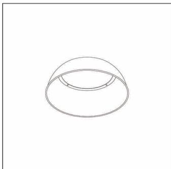
Highbay 42 S/L, réflecteur, orientation de la lumière primaire avec réflecteur, en aluminium, aluminium soft, diffusion de lumière: direct distribution, caractéristique d'éclairage primaire: symétrique en rotation, type de pose: en saillie, diamètre: 435mm, hauteur: 130mm, unité d'emballage: 1 pièce
